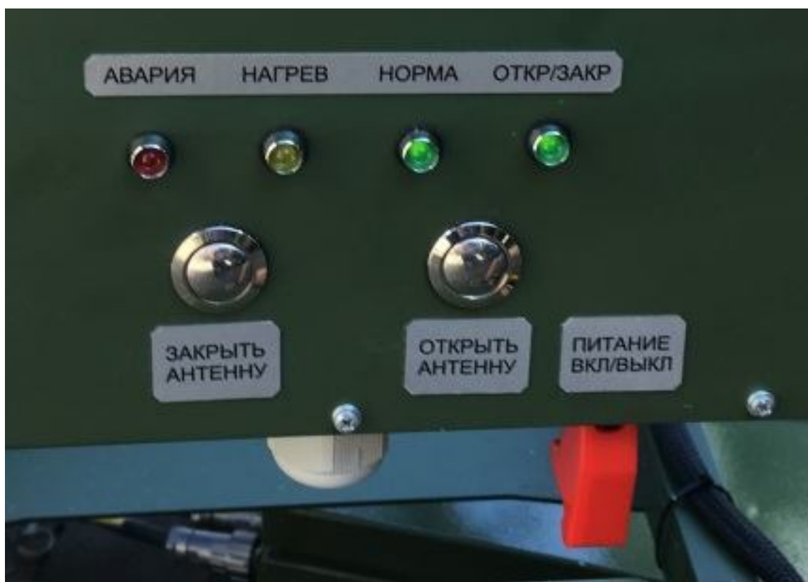
Рисунок 3.1 - Внешний вид элементов индикации и управления блока включения и контроля (БВК) ТИШЖ.468369.036
