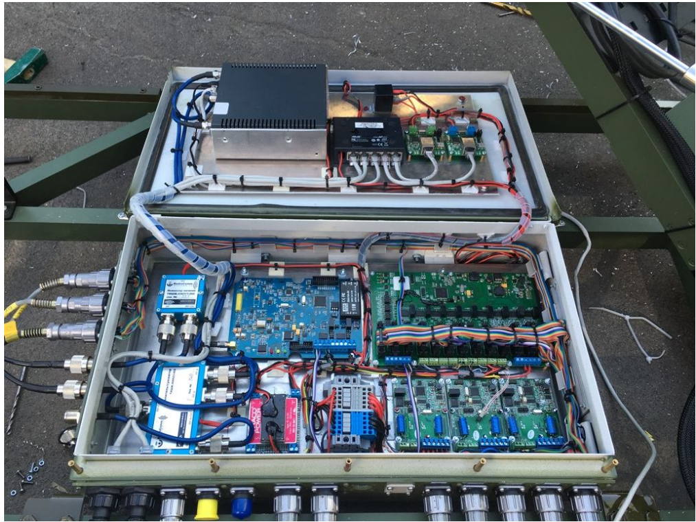
Рисунок 1.2.8 - Внешний вид БСНС ТИШЖ.468383.014 с открытой крышкой
