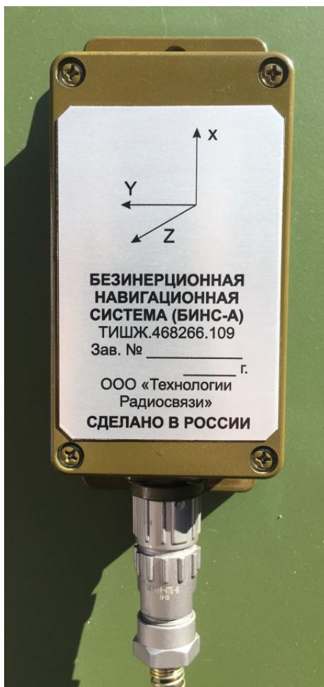
Рисунок 1.2.10 – Внешний вид БИНС-А ТИШЖ.468266.109
